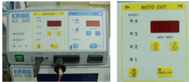
A. ภาพที่ 4 เครื่องจี้ไฟฟ้าที่มี endocut mode
