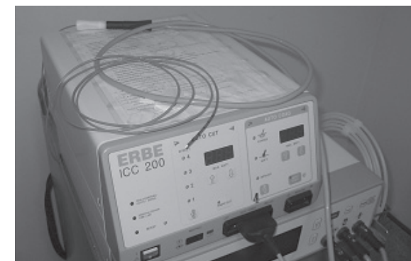
ภาพที่ 18 เครื่อง argon plasma coagulator พร้อมทั้ง probe ที่สามารถใช้กับกล้องส่องทางเดินอาหาร ในบางยี่ห้ออย่างเช่นเครื่องนี้ สามารถใช้ทั้ง monopolar และ bipolar coagulator ด้วย
