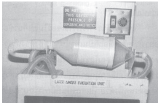
ภาพที่ 17 Smoke evacuator ซึ่งทำหน้าที่ดูดควันที่เกิดจากการเผาไหม้ของเนื้อเยื่อโดยแสงเลเซอร์
